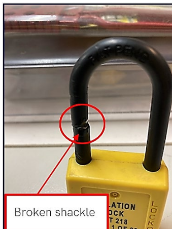
Photo 1 – Actual broken lock.
